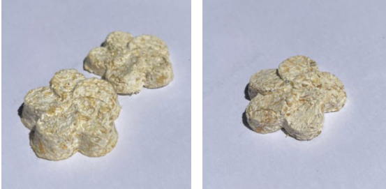
ภาพประกอบที่ 18 (ซ้าย) การขึ้นรูปด้วยแม่พิมพ์เป็นรูปทรงต่างๆ ด้วยแม่พิมพ์ซิลิโคน
