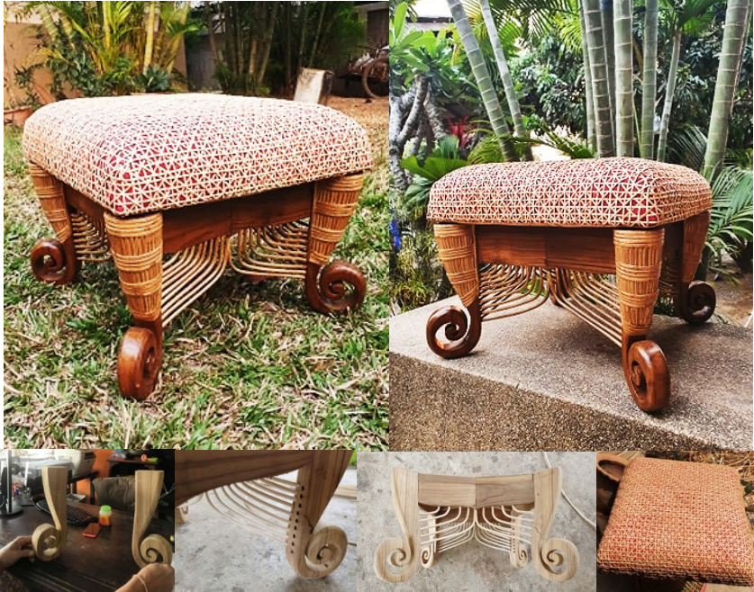
ภาพประกอบที่ 6 รูปแบบและโครงสร้าง KOOP-CHAIR 2 เป็นการพัฒนารูปแบบของแห่่ง (สัปคับ) ลักษณะถอดแบบเดิม แต่ปรับเปลี่ยนแนวคิดด้วยวิธีการสลับมุมมองจากเส้นฐานของเก้าอี้เข้าด้านใน การนำรูปแบบและลักษณะของซุ้มหลังคา (ประทุนทรงโค้ง) ของกุบหลังช้างมาใช้ในการปรับเปลี่ยนรูปแบบ ในส่วนของการออกแบบที่นั่งและขาของเก้าอี้ประกอบด้วยการแกะสลักไม้ของโครงสร้างขาตัว S, การประกอบด้วยการเจาะรูประกบ, ห่อผิวหวายหุ้มโครงสร้าง, การดัดโค้งหวายให้เกิดรูปทรง, จักสานเฉลียวสามเหลี่ยมหุ้มเบาะผ้า ที่มา: กิตติพงษ์ เกียรติวิภาค (2563)
