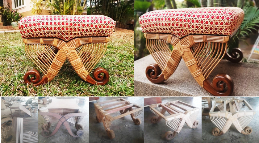
ภาพประกอบที่ 5 รูปแบบและโครงสร้าง KOOP-CHAIR 1 เป็นการพัฒนารูปแบบของแห่่ง (สัปคับ) ลักษณะการถอดแบบเดิม โดยมีการแกะสลักไม้ของโครงสร้างขาตัว S, การสลับไขว้, การประกอบ ด้วยการเจาะรูประกบ, ห่อผิวหวายหุ้มโครงสร้าง, ดัดโค้งหวายให้เกิดรูปทรงและการจักสาน ลายฉลุยวแปดเหลี่ยมหุ้มเบาะผ้า ที่มา: กิตติพงษ์ เกียรติวิภาค (2563)
