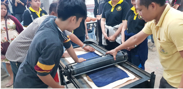
ภาพประกอบที่ 26 ภาพแสดงการทดสอบเครื่องรีดดินแบบแผ่นแบบตั้งโต๊ะและแบบมีขา โดยนักศึกษารายวิชาเลือกเสรีและนักศึกษาสาขาวิชาเซรามิกส์
