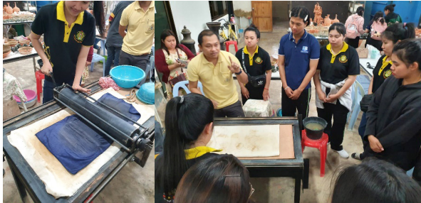
ภาพประกอบที่ 21 ภาพแสดงการทดสอบเครื่องรีดดินแบบแผ่นแบบตั้งโต๊ะและแบบมีขา โดยนักศึกษารายวิชาเลือกเสรีและนักศึกษาสาขาวิชาเซรามิกส์
