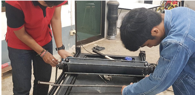
ภาพประกอบที่ 11 แสดงภาพเครื่องรีดดินแบบแผ่นแบบตั้งโต๊ะ
