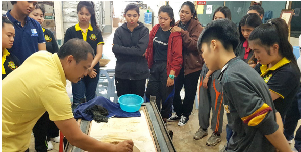
ภาพประกอบที่ 24 ภาพแสดงการทดสอบเครื่องรีดดินแบบแผ่นแบบตั้งโต๊ะและแบบมีขา โดยนักศึกษารายวิชาเลือกเสรีและนักศึกษาสาขาวิชาเซรามิกส์
