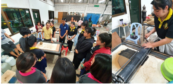
ภาพประกอบที่ 20 ภาพแสดงการทดสอบเครื่องรีดดินแบบแผ่นแบบตั้งโต๊ะและแบบมีขา โดยนักศึกษารายวิชาเลือกเสรีและนักศึกษาสาขาวิชาเซรามิกส์
