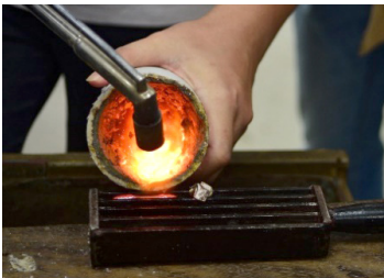
ภาพประกอบที่ 1 การหลอมเงินการรีดแผ่นเงิน
