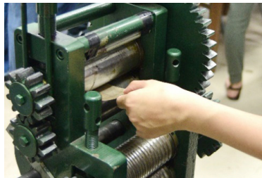
ภาพประกอบที่ 1 การหลอมเงินการรีดแผ่นเงิน
