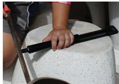
ภาพที่ 18 ขัดก้านจับด้วยตะไบแบน ที่มา : ผู้วิจัย
