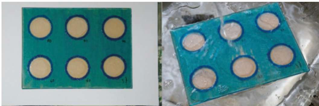
ภาพที่ 6 ทำการแยกหยดไดคลอโรมีเทน 49, 50, 57, 60, 80, 84 หยด แล้วล้างชั้นเคลือบโดยรอบออกด้วยน้ำ ที่มา : ผู้วิจัย
