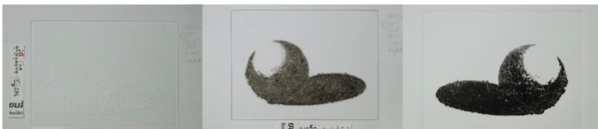
ภาพที่ 15 สภาพแม่พิมพ์ก่อนหลังการอัดหมึกพิมพ์ และผลลัพธ์จากการพิมพ์ จากการทดลอง (เพื่อยืนยันผล) ครั้งที่ 3 ที่มา : ผู้วิจัย
