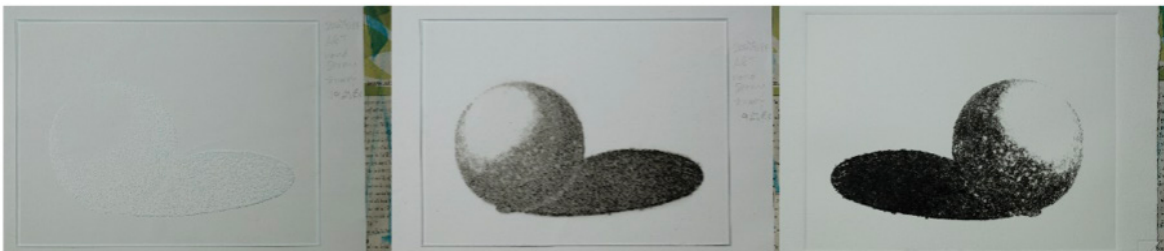
ภาพที่ 13 สภาพแม่พิมพ์ก่อนหลังการอัดหมึกพิมพ์ และผลลัพธ์จากการพิมพ์ จากการทดลองครั้งที่ 1 ที่มา : ผู้วิจัย
