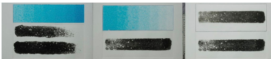
ภาพที่ 11 ภาพเปรียบเทียบปริมาณการพ่นแฮนด์สเปรย์ ค่าน้ำหนักที่ได้จากการพิมพ์ และสภาพแม่พิมพ์ที่ผ่านการอัดหมึกพิมพ์ ที่มา : ผู้วิจัย
