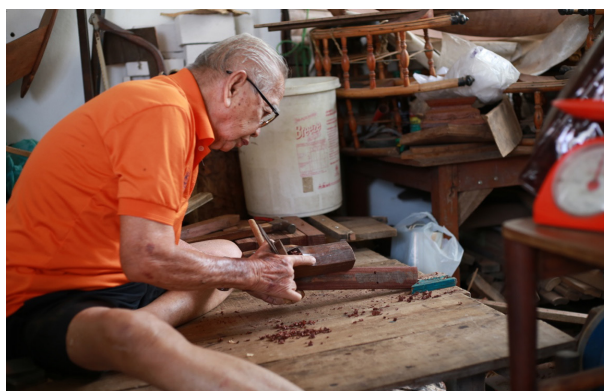
ภาพที่ 11 ครูชลอ ใจชื่น ใช้กับไสไม้แต่งฝืนระนาเดกด้านบน ที่มา : ผู้วิจัย
