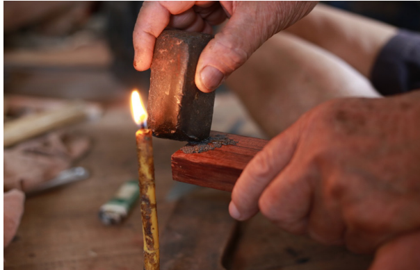
ภาพที่ 12 ครูชลอ ใจชื้น ติดตะกั่วลูกระนาดเอก ที่มา : ผู้วิจัย
