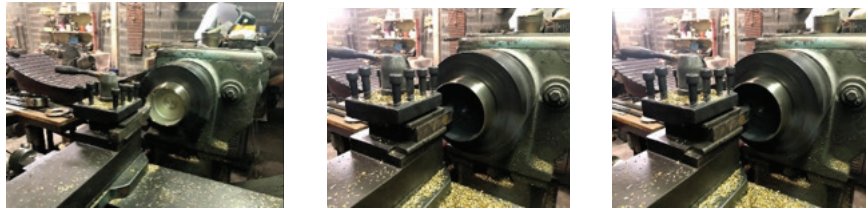
ภาพรวมที่ 4 ปาดแต่งฉัตรบนด้านในของลูกช้อง ที่มา : ผู้วิจัย บันทึกภาพเมื่อ 13 กุมภาพันธ์ พ.ศ.2563
