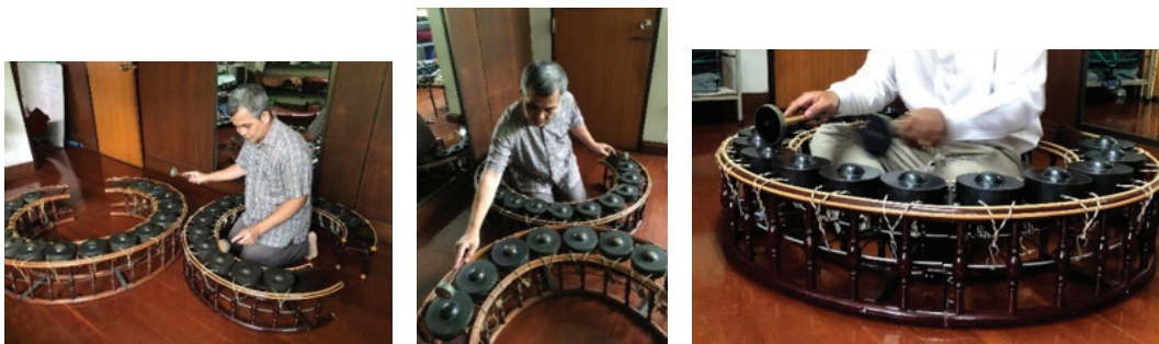
ภาพรวมที่ 10 ทดสอบเสียงฆ้องที่ผลิตด้วยการหล่อลดขนาดและตกแต่งเสียงเสร็จสิ้นแล้ว
