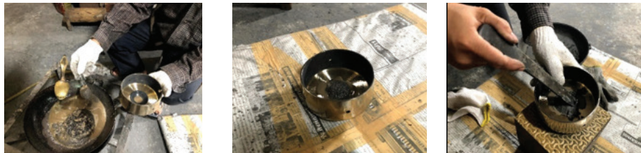
ภาพรวมที่ 5 การหยอดตะกั่วผสมซีฟิ่งลงในปุ่มช้อง และการปาดแต่งตะกั่วให้ได้ระดับเสียงตามต้องการ ที่มา : ผู้วิจัย บันทึกภาพเมื่อ 13 กุมภาพันธ์ พ.ศ.2563
