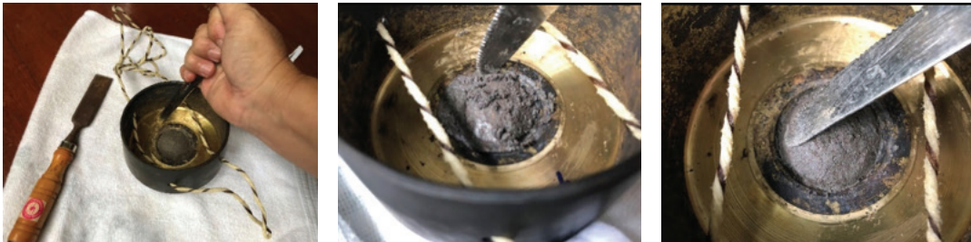
ภาพรวมที่ 7 ปาดแต่งเนื้อโลหะด้านในของฉัตรบน และใช้ตะกั่วเทียบเสียงเป็นขั้นสุดท้าย ที่มา : ผู้วิจัย บันทึกภาพเมื่อ 19 เมษายน พ.ศ.2566
