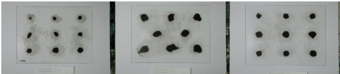
ภาพที่ 4 สภาพแม่พิมพ์หลังจากการอัดหมึกพิมพ์ ตัวอย่าง ที่ 1 ที่ 2 และที่ 3 ที่มา : ผู้วิจัย
