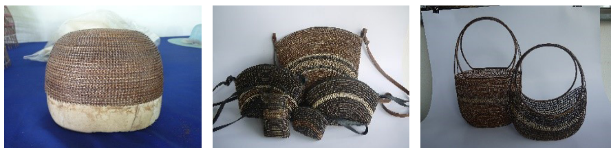
ภาพที่ 12-14 แสดงวิธีการขึ้นรูปแบบโปร่งและรูปทรงของผลิตภัณฑ์ที่ได้
