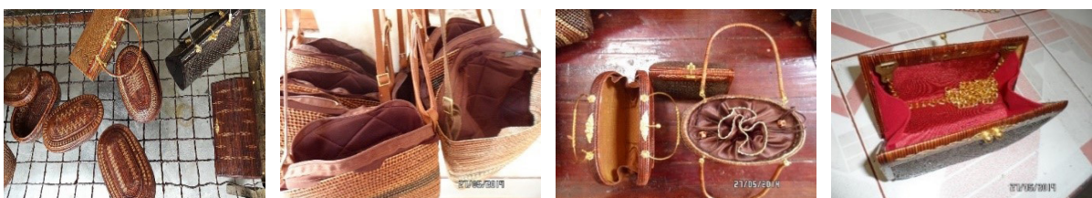
ภาพที่ 21-24 แสดงการเคลือบผิวผลิตภัณฑ์ และการประกอบชิ้นส่วนระหว่างตัวกับฝา การต่อเข้ากับหูหิ้วและอุปกรณ์สำหรับการยึด การล็อก บานพับหรือการนูนด้านในด้วยผ้าไหม การนูนด้านในด้วยผ้ากำมะหยี่ ในผลิตภัณฑ์ประเภทกระเป๋า หรือการเย็บติดกับตัวกระเป๋า ด้านในที่ทำด้วยผ้าในผลิตภัณฑ์ประเภทกระเป๋าสะพาย เป็นต้น
