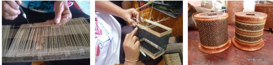
ภาพที่ 6-8 แสดงวิธีการขึ้นรูปด้วยการขึ้นกรองและรูปทรงของผลิตภัณฑ์ที่ได้
