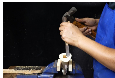
ภาพที่ 15 การกลึงเข้ารูปลูกบิด ภาพที่ 16 การเข้าปากซ้าง ที่มา: อนันต์สิทธิ์ การหนองใหญ่
