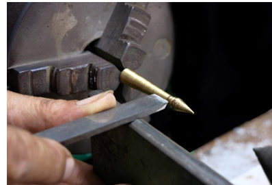
ภาพที่ 13 การกลึงเข้ารูปทวนบน ภาพที่ 14 การกลึงเข้ารูปทวนล่าง ที่มา: อนันต์สิทธิ์ การหนองใหญ่
