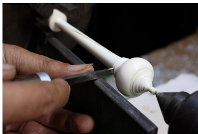
ภาพที่ 15 การกลึงเข้ารูปลูกบิด ภาพที่ 16 การเข้าปากซ้าง ที่มา: อนันต์สิทธิ์ การหนองใหญ่
