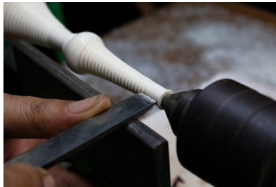
ภาพที่ 13 การกลึงเข้ารูปทวนบน ภาพที่ 14 การกลึงเข้ารูปทวนล่าง ที่มา: อนันต์สิทธิ์ การหนองใหญ่
