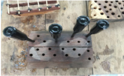
ภาพที่ 8 และ 9 ภาพที่ปักลูกบิดและคันทวน และ ที่จับสำหรับพ่นสี ที่มา: ธีรพงศ์ คำโปรง
