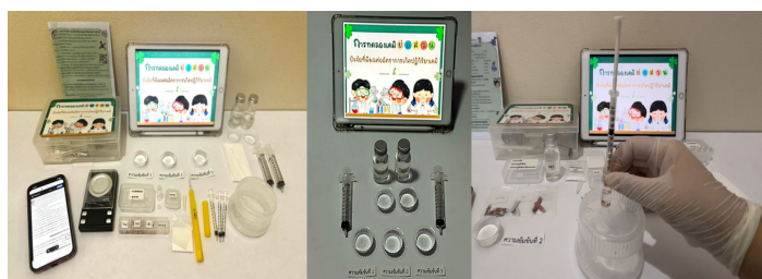
ภาพที่ 1 การทดลอง เรื่อง ความเข้มข้นของสารตั้งต้นที่มีผลต่ออัตราการเกิดปฏิกิริยาเคมี
