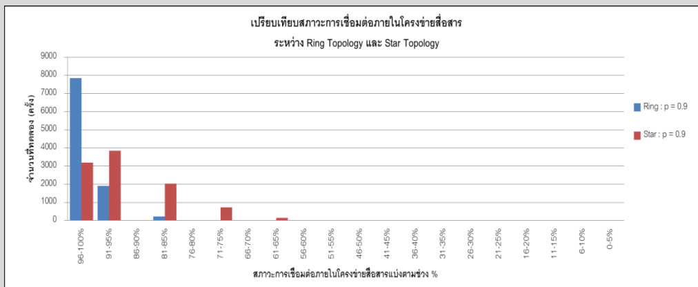
รูปที่ 7 ผลการเปรียบเทียบสภาวะการเชื่อมต่อภายในโครงข่ายสื่อสารทั้งแบบวงแหวนและแบบดาว
