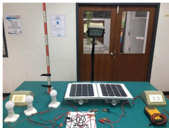
(ข) การต่อวงจรไฟฟ้ากระแสตรงของระบบผลิตกระแสไฟฟ้าด้วยเซลล์แสงอาทิตย์
