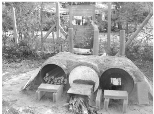
ภาพที่ 2 เตาเผาถ่าน 200 ลิตร ชนิดแนวตั้งแบบง่าย (ภาพซ้าย) ชนิดแนวนอน (ภาพขวา)
