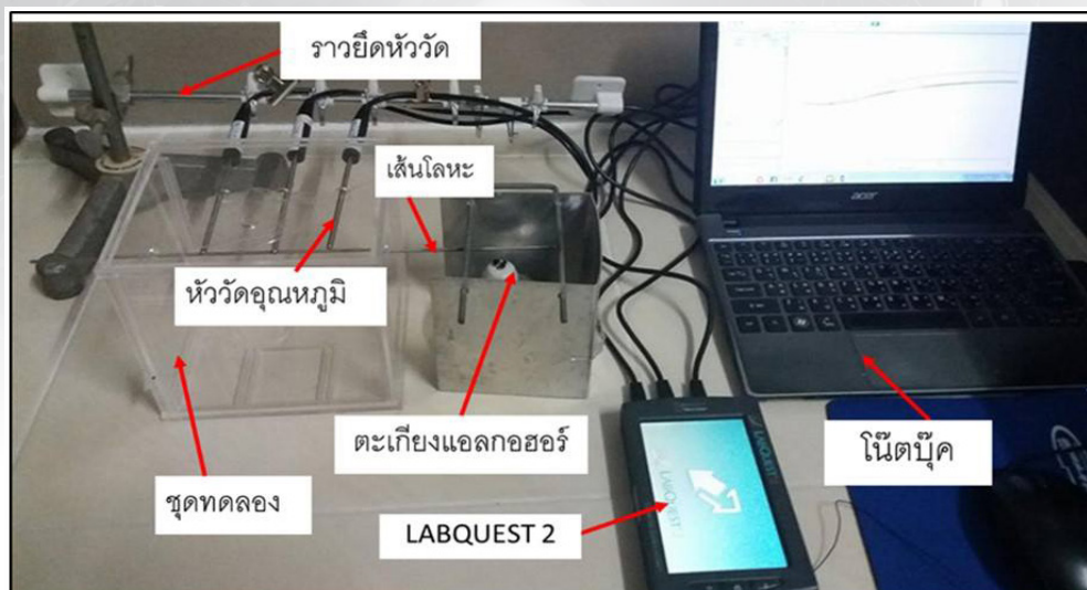
ภาพที่ 3 ตัวอย่างชุดปฏิบัติการทดลองผ่านคอมพิวเตอร์ในหน่วยย่อย เรื่อง จนวนความร้อน คุณภาพสูง ที่ใช้ในโมดูลการเรียนรู้สะเต็มบนฐานวิทยาศาสตร์สืบเสาะ
