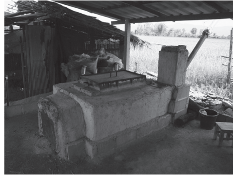
ภาพที่ 6 แสดงเตาต้มก้อนเชื้อเห็ดที่ปรับปรุงใหม่
