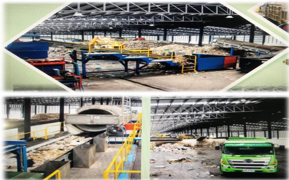
ภาพที่ 1 ภาพกระบวนการผลิตพลังงานเชื้อเพลิงขยะ RDF
