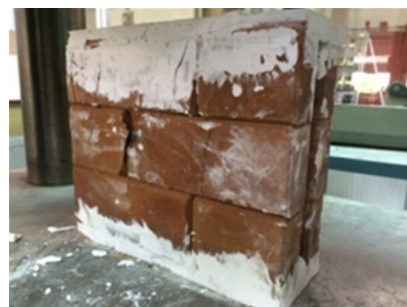
(ข) การทดสอบกำลังอัดแบบปริซึม
