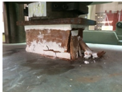
(ข) การทดสอบกำลังอัดต่อก้อน
