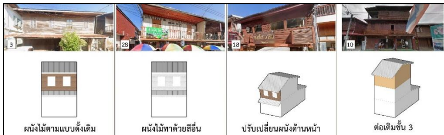
ภาพที่ 7 การปรับเปลี่ยนโครงสร้างและผนังส่วนห้องพัก
