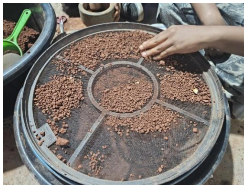
ภาพที่ 1 กระบวนการร่อนดินลูกรังผ่านตะแกรงเบอร์ 4
