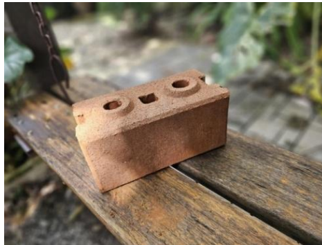
ภาพที่ 5 ต้นแบบผลิตภัณฑ์บล็อกประสานสำหรับงานภูมิทัศน์จากยางครัมป์ สูตรที่ 4
