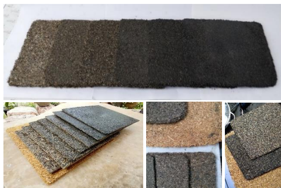
ภาพที่ 3 แผ่นขึ้นไม้อัดที่พัฒนาในโครงการ (เศษไม้ฝัดผสมกากกาแฟโดยใช้วิธีการผลิตของชุมชน)
