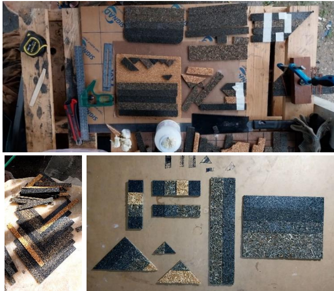
ภาพที่ 10 เทคนิคการตัดและต่อชิ้นไม้โดยการสลับสี เพื่อให้เกิดลวดลาย
