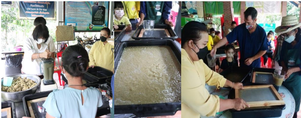
ภาพที่ 5 การกระจายเยื่อ (ปั่นเยื่อ)
