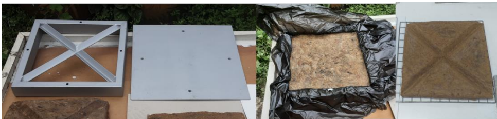
ภาพที่ 10 การพัฒนาต้นแบบครั้งที่ 1 บล็อกพิมพ์เหล็กและ ต้นแบบบล็อกจากส่วนผสมเส้นใยตาลโดนด
