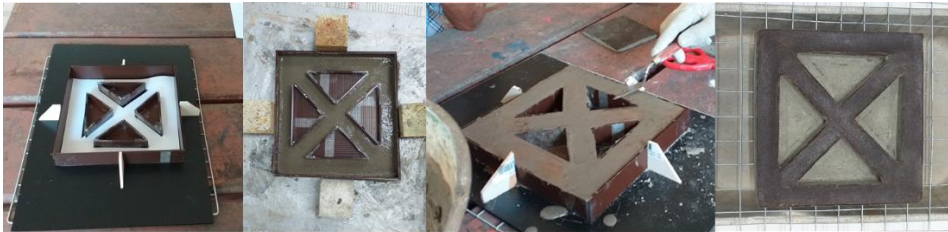
ภาพที่ 11 การพัฒนาต้นแบบครั้งที่ 2 พัฒนาล็อกพิมพ์จากแผ่นพลาสติกและ พัฒนาส่วนผสมเส้นใยตาลโตนด
