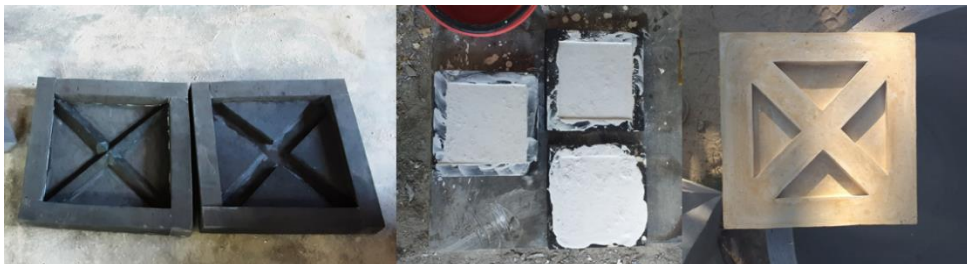
ภาพที่ 12 การพัฒนาต้นแบบครั้งที่ 3 พัฒนาล็อกพิมพ์จากโฟมอัดและ พัฒนาส่วนผสมเส้นใยตาลโตนด
