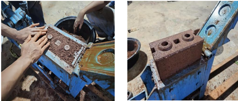
ภาพที่ 2 การขึ้นรูปบล็อกประสานในเครื่องอัดบล็อก
