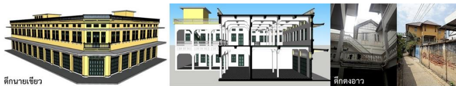
ภาพที่ 5 ตึกแถวสไตล์โคโลเนียลกลุ่มที่ 3 โครงสร้าง ค.ส.ล. ผสานกับโครงสร้างไม้ผืนงก่ออิฐเต็มแผ่น
