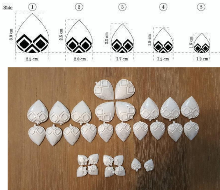
ภาพที่ 12 ขนาดและผลงานต้นแบบในการหล่อเหวี่ยง กิจกรรมที่ 2
