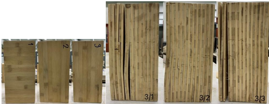
ภาพที่ 4 ลักษณะการวิบัติของเสาตัวอย่าง CS(1/1-3), CM (2/1-3) และ CL (3/1-3) ที่มา: เกษราภรณ์ พานะตร และ ชลดา อ่อนนุ่ม (2564)
