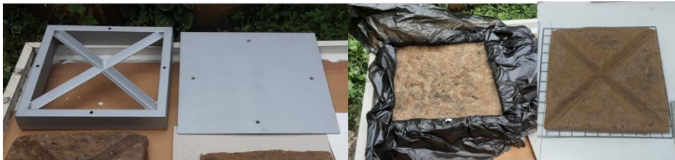
ภาพที่ 10 การพัฒนาต้นแบบครั้งที่ 1 บล็อกพิมพ์เหล็กและต้นแบบบล็อกจากส่วนผสมเส้นใยตาลโตนด
