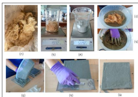
ภาพที่ 3 วิธีการผสมแผ่นซีเมนต์เส้นใยจากผลตาลโตนด
