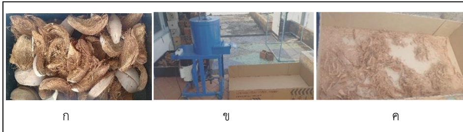
ภาพที่ 4 (ก) วัตถุดิบกาบมะพร้าว(ข) เครื่องย่อยกาบมะพร้าว และ (ค) เส้นใยมะพร้าวที่ผ่านการย่อยแล้ว
