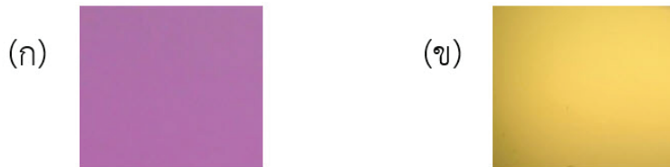
ภาพที่ 8 สีของฟิล์มบางที่เคลือบลงบนกระจกหนา 1 มิลลิเมตร โดยที่ (ก) ทองสีม่วง (AuAl 2 ) และ (ข) แพลทินัมสีเหลือง (PtAl 2 ) ที่มา: ภาพถ่ายจากผู้วิจัย
