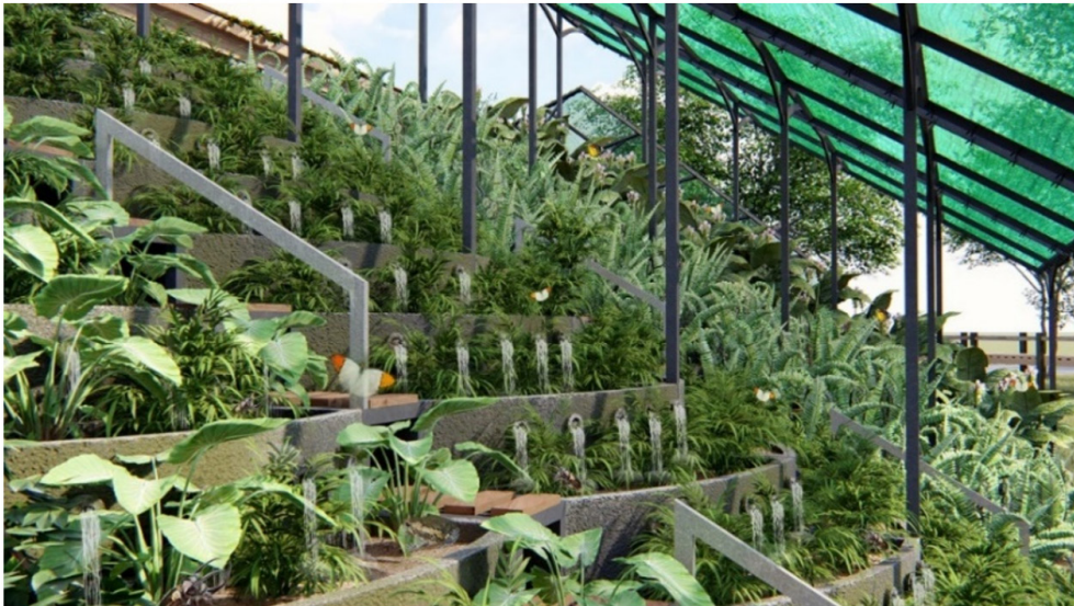
ภาพที่ 13 ท่อปล่อยน้ำของวัสดุ GRC เพื่อให้ความชุ่มชื้นแก่พืชและหน้าดิน
