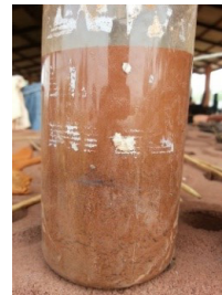
(ข) การทดลองการตกตะกอนของดิน
