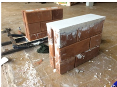
(ก) ก้อนตัวอย่างสำหรับทดสอบกำลังแบบปริซึม
