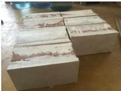
(ก) ก้อนตัวอย่างสำหรับทดสอบกำลังอัดต่อก้อน
