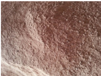
(ก) ตัวอย่างดินลูกรังที่เข้าเครื่องตีดินละเอียดแล้ว
