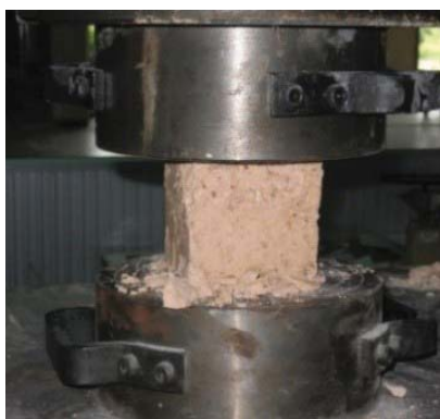
ภาพที่ 3 การทดสอบค่ากำลังอัดของดินด้วยเครื่องทดสอบ Universal Testing
