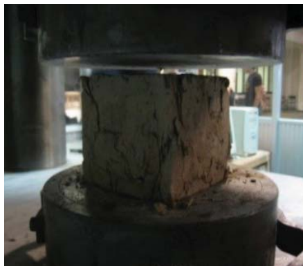
ภาพที่ 3 การทดสอบค่ากำลังอัดของดินด้วยเครื่องทดสอบ Universal Testing
