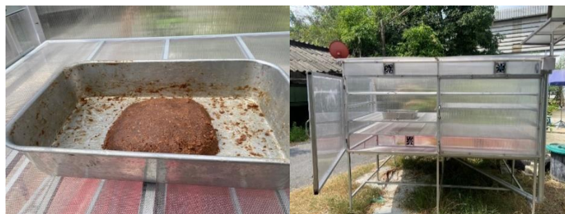
ภาพที่ 8 การตากต้นแบบกะปิในตู้อบตู้อบพลังงานแสงอาทิตย์ ที่มา: นักวิจัย
