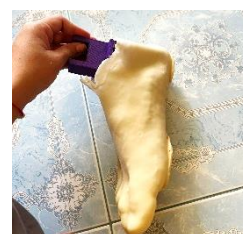
ค. ทดลองใส่ชิ้นงานเท้าเทียมเพื่อทำการหล่อเท้าด้วยน้ำยางพารา
