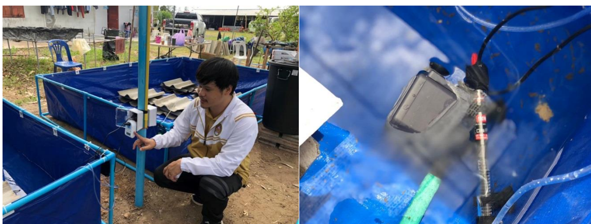
แผนภาพที่ 4 การติดตั้งควบคุมอุณหภูมิน้ำ แหล่งที่มา : โดยผู้วิจัย
