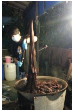
ภาพที่ 1.6 การแช่น้ำโคลน
