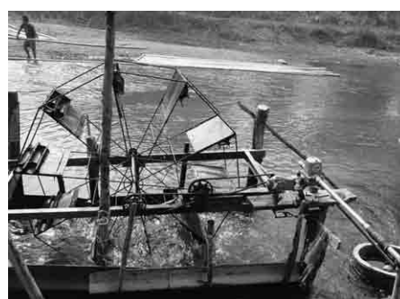
ภาพที่ 7 การนำน้ำมาใช้โดยใช้กังหันวิดน้ำ
