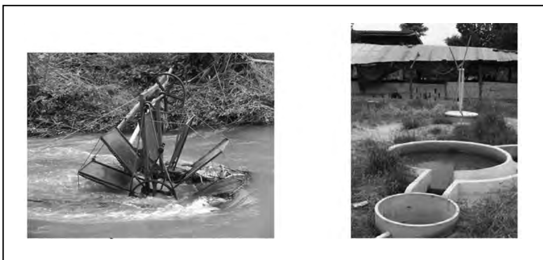
ภาพที่ 5 กังหันน้ำภูมิปัญญาชาวบ้าน และบ่อหมักก๊าซชีวภาพ
