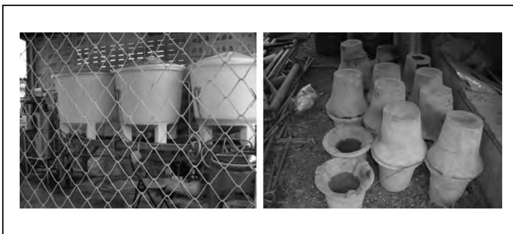
ภาพที่ 4 เครื่องผลิตไบโอดีเซลชุมชนขนาด 200 ลิตร และเตาเผาถ่านประสิทธิภาพสูง
