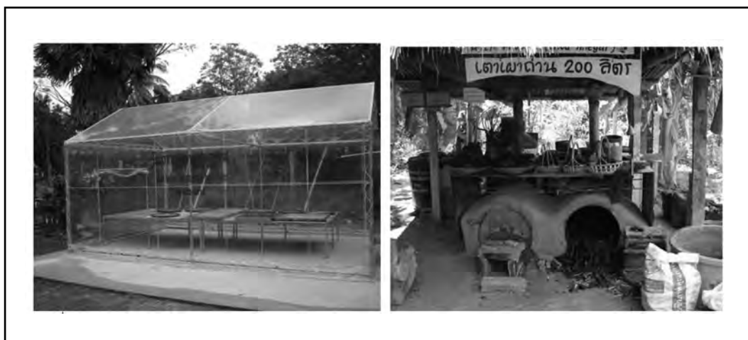
ภาพที่ 3 โรงตากพลังงานแสงแดด และเตาเผาถ่านขนาด 200 ลิตร
