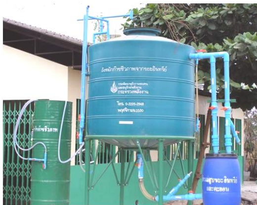
ภาพที่ 8 ถังตัวอย่างสำหรับหมักก๊าซชีวภาพจากขยะอินทรีย์ของกระทรวงพลังงาน
