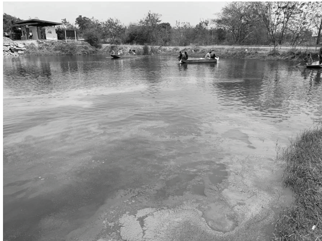
ภาพที่ 11 การเกิด Green algal flocc (scum) ลอยบนผิวน้ำทันทีหลังจากที่มีการใส่สารส้มลงไป ระหว่างการทำการทดลองที่บึงก อ.เมือง จ.ขอนแก่น
