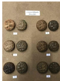
ภาพที่ 10 ภาพการทดลองสารให้สีน้ำตาลในเนื้อดินหลักครั้งที่ 2 หลังจากการเผาที่อุณหภูมิ 1200 °C
