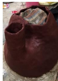
ภาพที่ 2 วิธีการขึ้นรูปแบบกด
