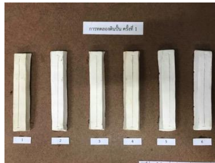
ภาพที่ 6 ผลการทดลองเนื้อดินหลัก หลังการเผาด้วยอุณหภูมิ 1200 °C
