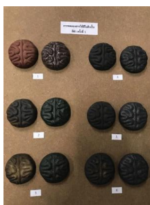
ภาพที่ 8 ภาพการทดลองสารให้สีดำในเนื้อดินหลักครั้งที่ 1 หลังจากการเผาที่อุณหภูมิ 1200 °C
