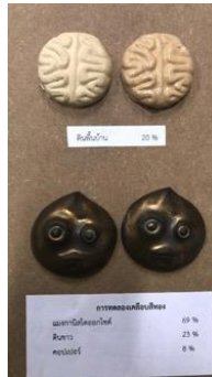
ภาพที่ 11 ภาพการทดลองน้ำเคลือบครั้งที่ 1 เคลือบสีไฟสูง และเคลือบสีทองหลังจากการเผาที่อุณหภูมิ 1200 °C
