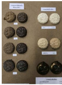
ภาพที่ 9 ภาพการทดลองสารให้สีดำในเนื้อดินหลักครั้งที่ 2 หลังจากการเผาที่อุณหภูมิ 1200 °C
