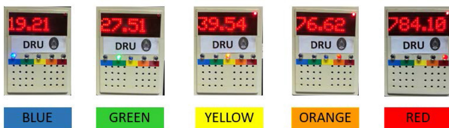
ภาพที่ 4 การแสดงค่าฝุ่นละอองขนาดเล็กและการติดสว่างของหลอดแอลอีดีแสดงผลด้วยสีตามระดับค่าดัชนีคุณภาพอากาศที่กรมมลพิษกำหนด
