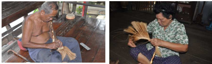
ภาพที่ 10 การถักหวายร้อยเส้นใยมะพร้าวประกอบเข้ากับด้าม
