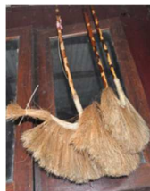
ภาพที่ 12 การนำด้ามไม้กวาดใยมะพร้าวที่ทำเสร็จแล้วมาทาน้ำมันสนชักเงา
